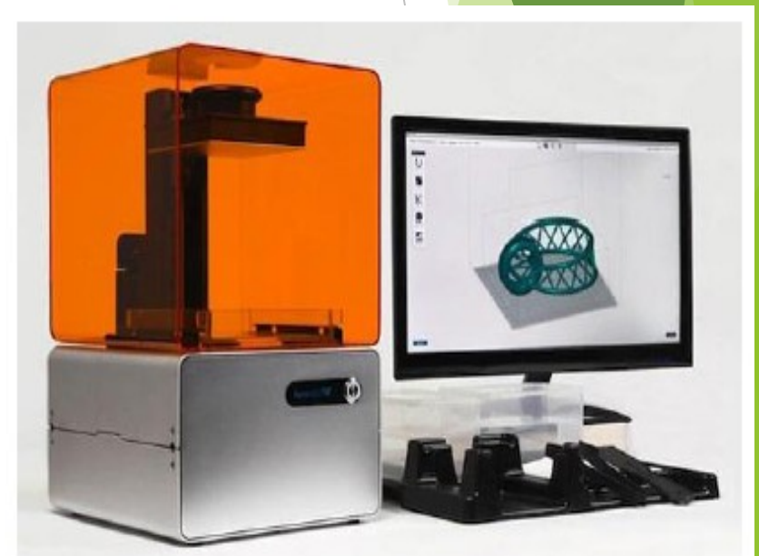
Εικόνα 2: 3D εκτυπωτής που χρησιμοποιεί την μέθοδο της στερεολιθογραφίας και το σχεδιαζόμενο μοντέλο
