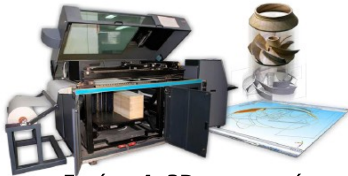
Εικόνα 4: 3D εκτυπωτής που χρησιμοποιείται στην τεχνική Laminated Object Manufacturing
